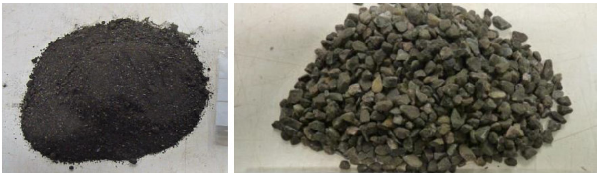
Abbildung 3: Bindemittelreiche Fraktion (links) und die bindemittelarme Fraktion (rechts) des in dem Rotorschleuderbrecher bearbeiteten Asphaltgranulates (17)
