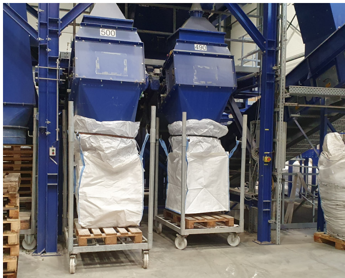
Abbildung 10: Absiebung in Fraktionen 0/2 \text{ mm} und \geq 2 \text{ mm} des Materialaustrages aus dem Rotorschleuderbrecher (links) und Absiebung (rechts)
