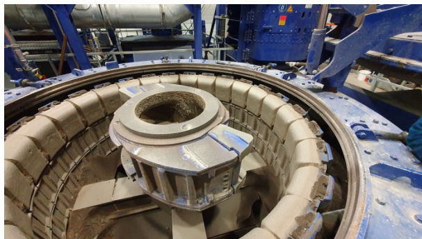
Abbildung 9: Rotorschleuderbrecher RSMX mit Auskleidung Ringpanzer (links) und Materialbett (rechts) im Technikum der BHS Sonthofen GmbH
