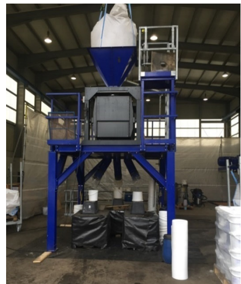
Abbildung 10: Absiebung in Fraktionen 0/2 \text{ mm} und \geq 2 \text{ mm} des Materialaustrages aus dem Rotorschleuderbrecher (links) und Absiebung (rechts)
