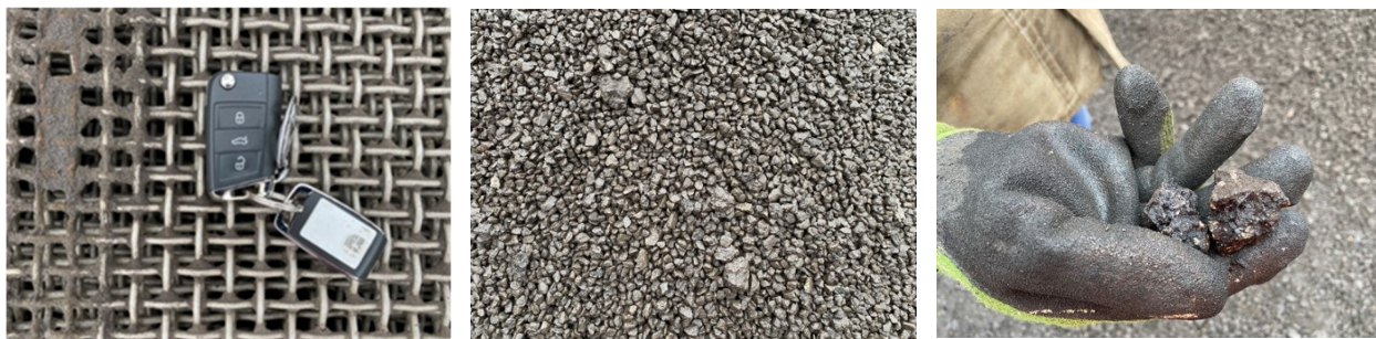
Abbildung 127: Verklebte Quadrat-Maschensiebe (links), Konglomerate nicht aufgebrochenen Materials bei den Fraktionen > 9 mm (Mitte und rechts)
