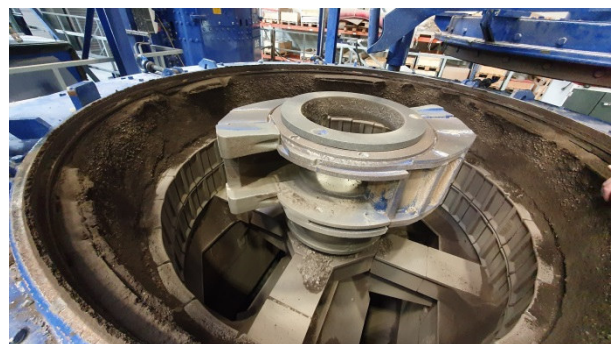
Abbildung 9: Rotorschleuderbrecher RSMX mit Auskleidung Ringpanzer (links) und Materialbett (rechts) im Technikum der BHS Sonthofen GmbH
