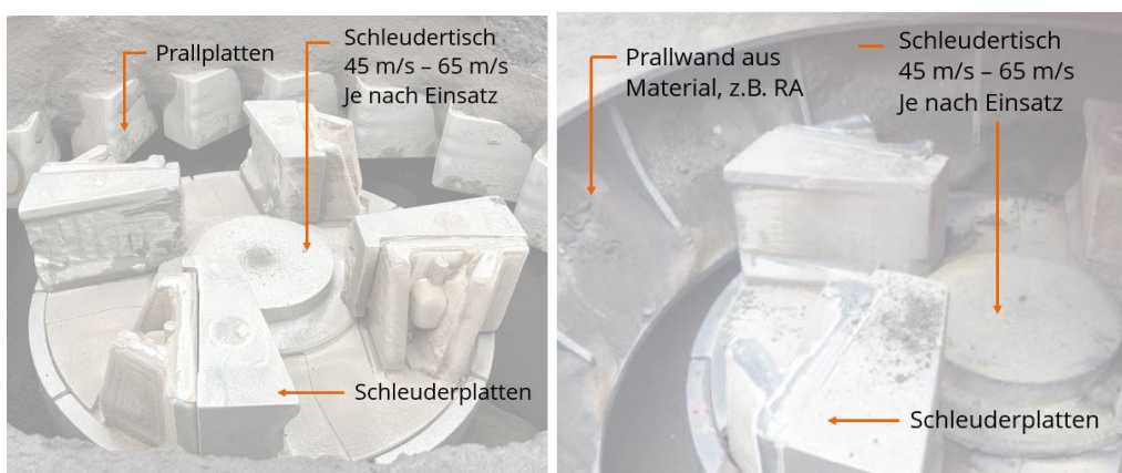
Abbildung 22: Vertikalbrecher mit Prallplattenring (links) und Materialbettring (rechts) (45)
