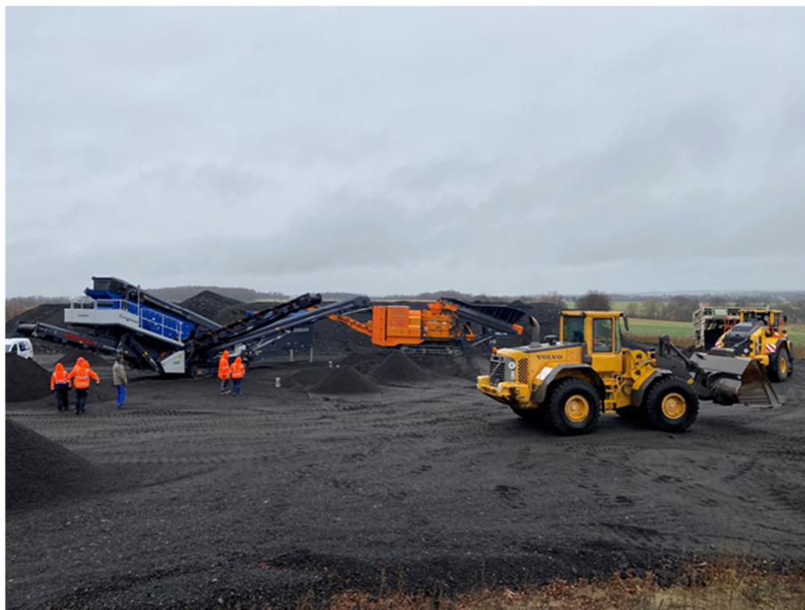
Abbildung 21: Von links nach rechts angeordnet, das Recyclingsieb SBR 2 Semimobil, der raupenmobile Vertikalbrecher Mag-Impact PTM 2100-2 und die Mobiscreen MSC 703i EVO
