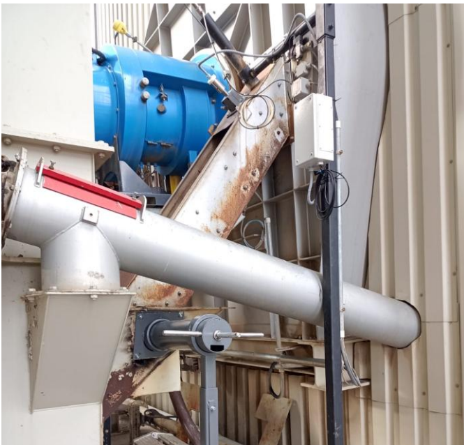
Abbildung 1. Lage des Analysators und die eigenentwickelte spezielle Vorrichtung zur Entnahme von Proben aus dem Massenstrom
