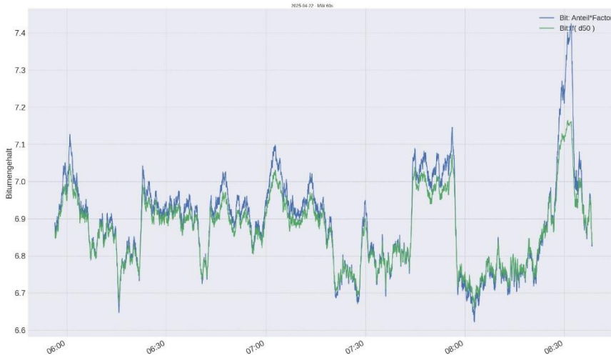
Abbildung 16. Zeitabhängiger Verlauf der Online Ermittlung des Bitumenanteils, grüne Linie berechnet auf Basis der Korrelation des online ermittelten D50-Wertes und blaue Linie auf Basis der Korrelation des online ermittelten Stückgrößenverteilung
