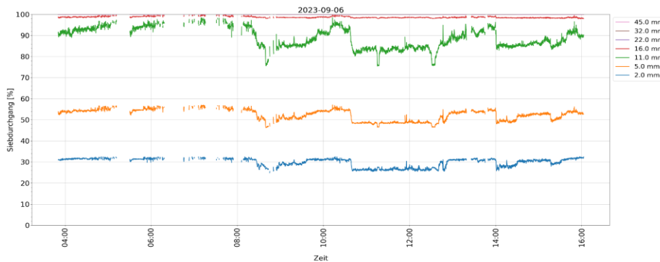
Abbildung 12. Online Korngrößenanalyse des Massenstroms über eine Produktionsdauer von 12 Stunden
