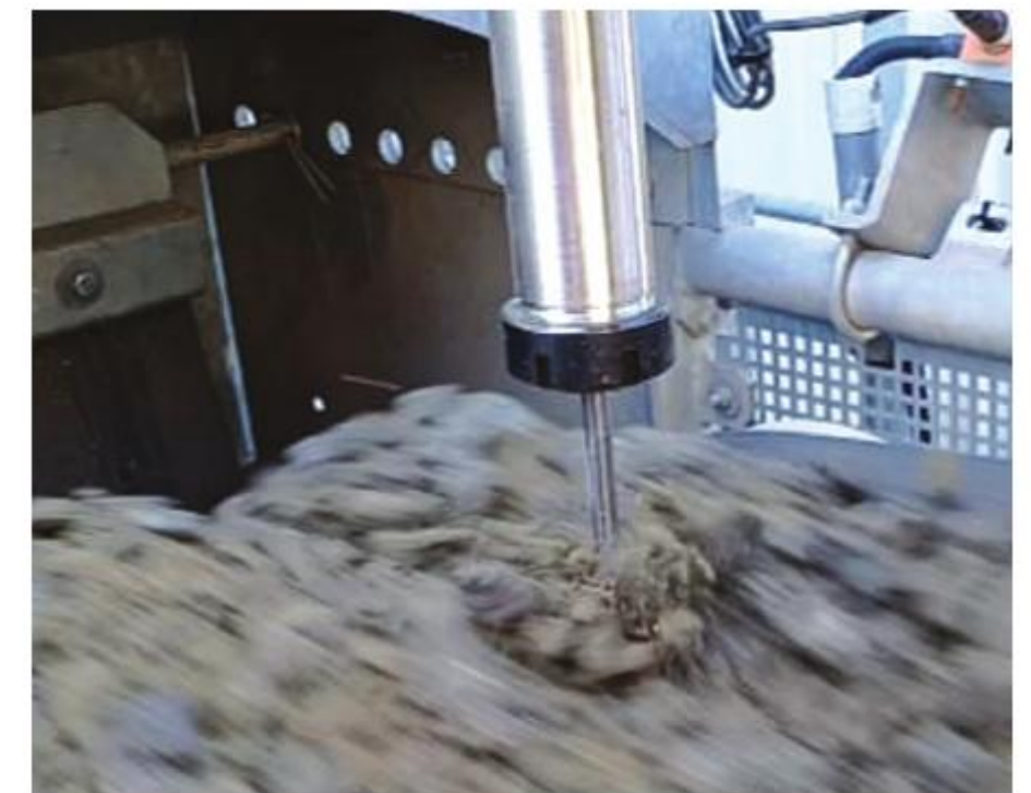
Bild 3: Geoscanner im Strom des Gesteinskörnungsgemisches vor der Trockentrommel (Quelle: Basalt-Actien-Gesellschaft)
