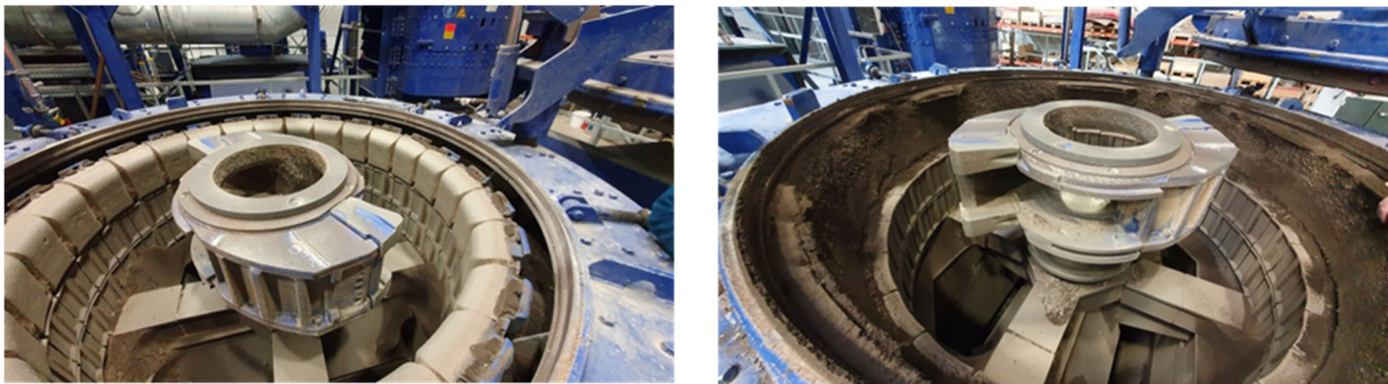
Abbildung 1: Rotorschleuderbrecher RSMX mit Auskleidung Ringpanzer (links) und Materialbett (rechts) im Technikum der BHS Sonthofen GmbH
