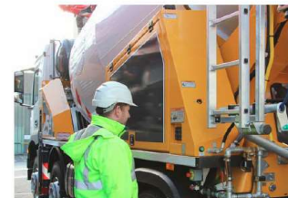
Abb. 26 Abfahrtskontrolle der Fahrmischerbetonpumpe durch den Fahrer
