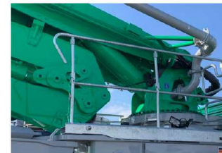
Abb. 24 Arbeitspodest und Absturzsicherung an der Betonpumpe
