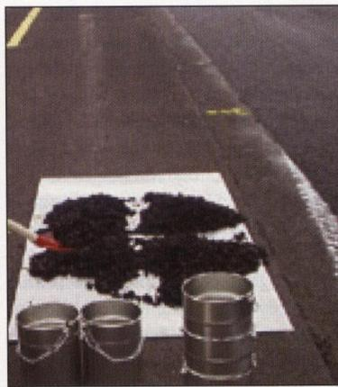
Bild 2: Probeteilung von Mischgut gemäß DIN 1996, Blatt 2
