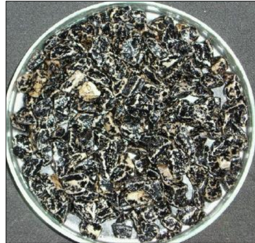
Umhüllungsgrad 70 % nach 24 h mit Haftverbesserer
