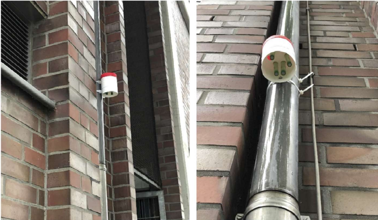
Abbildung 4: Im Straßenraum befestigter Schutzbehälter mit vier Passivsammlern
