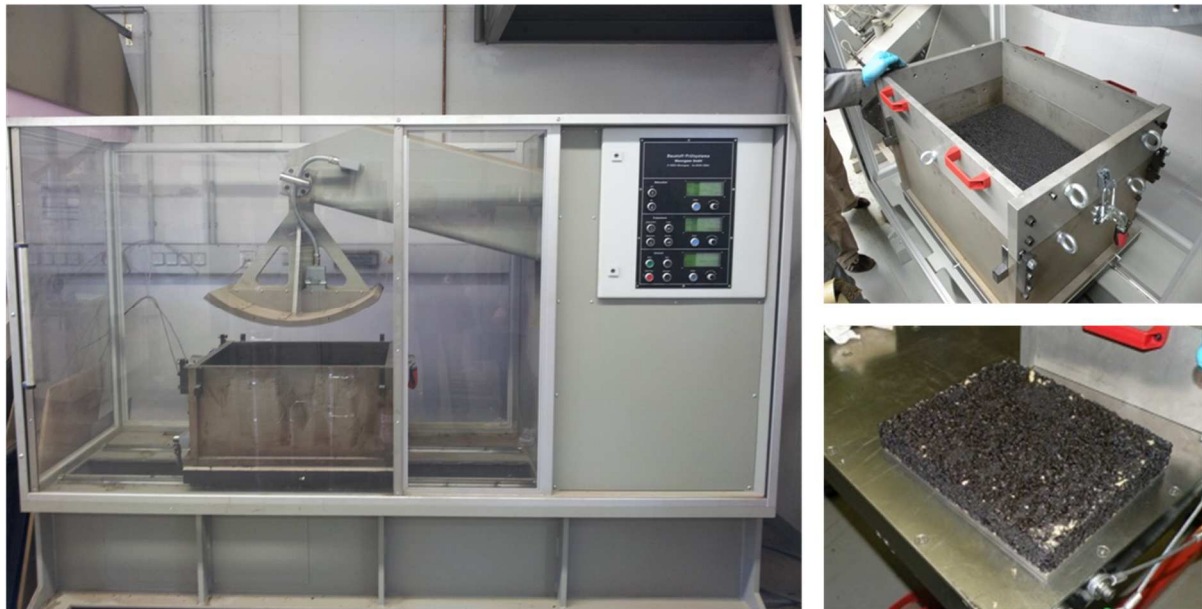
Abbildung 22. Walzsektor-Verdichtungsgerät zur Herstellung großformatiger Asphalt-Probeplatten (500 x 700 mm 2 ) (ISBS).
