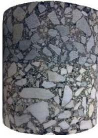
Abbildung 1.1: Schichtengrenzfläche bei der Kombination Asphaltbinderschicht-Asphalttragschicht
