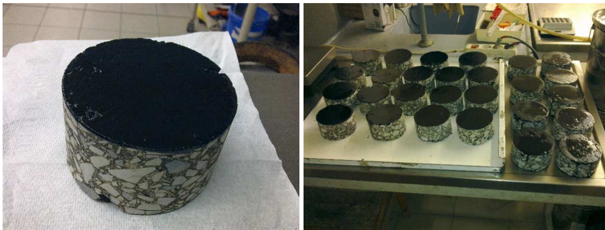
Abbildung 2.3: Geschliffene Oberfläche der unteren Asphaltschicht mit aufgetragener Bitumenemulsion.
