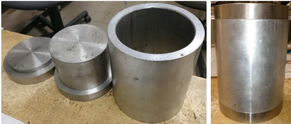
Abbildung 2.4: Speziell angefertigte Form zur Herstellung des Schichtenverbundes zwischen geschliffenen Oberflächen. Links – Teile, rechts – geschlossene Form.
