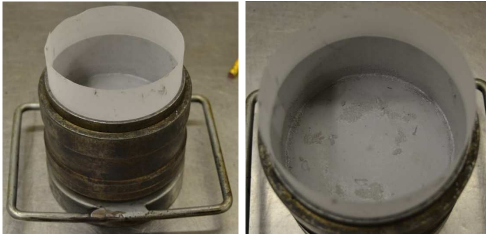
Abbildung 3.19: Formzylinder mit überzogener Innenwand (links) und geglättete Oberfläche des Epoxidharzklebergemisches (rechts)
