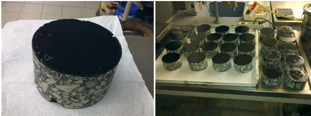
Abbildung 5.24: Geschliffene Oberfläche der unteren Asphaltsschicht mit aufgetragener Bitumenemulsion
