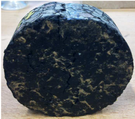
Abbildung 3.17: Rissbildung im Asphaltprobekörper nach dem Ermüdungsversuch (Asphaltdeckschicht SMA 11 S)
