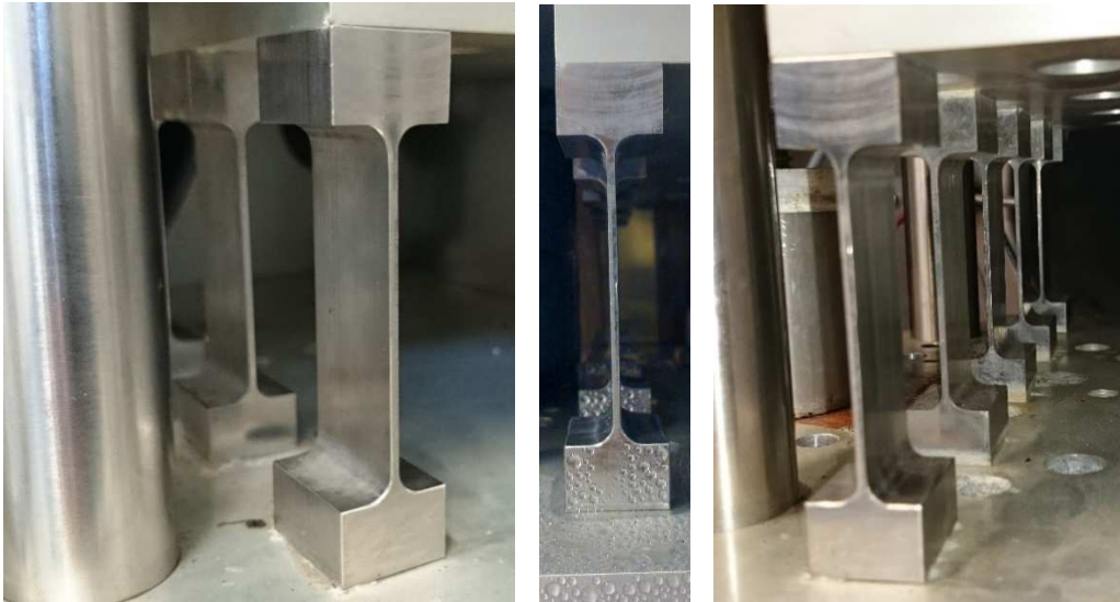
Abbildung 5.5: Präzisionslagern aus Edelstahl zur Vermeidung der vertikalen Bewegung des horizontal beweglichen Trägers
