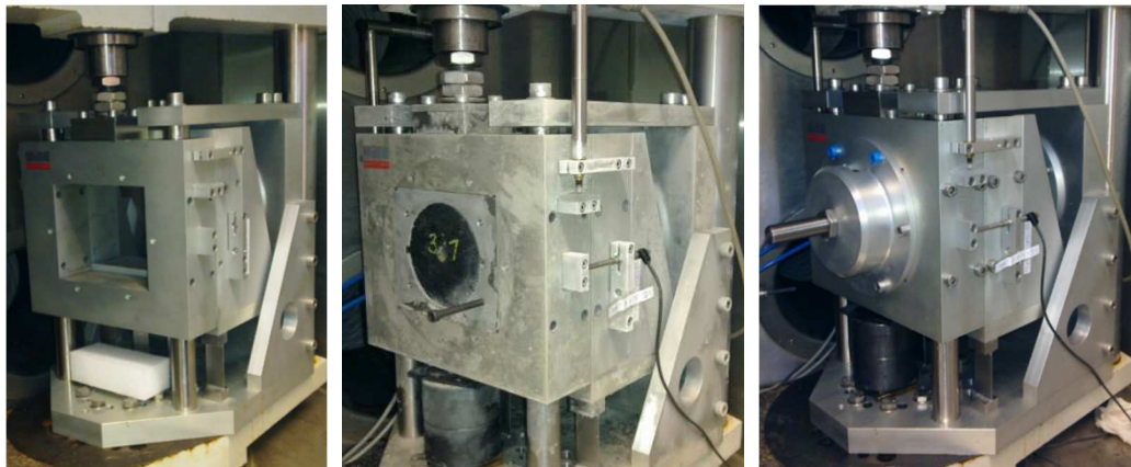
Abbildung 3.6: Vorrichtung für die zyklische Prüfung des Schichtenverbundes ohne und mit eingebautem Probekörper
