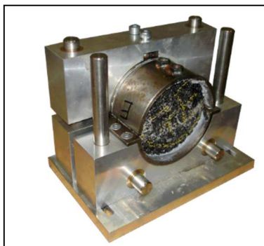
Abbildung 2.24: Vorbereitungsvorrichtung zum Einkleben der Probekörper in den 4 Halbschalen nach Ascher (2007)
