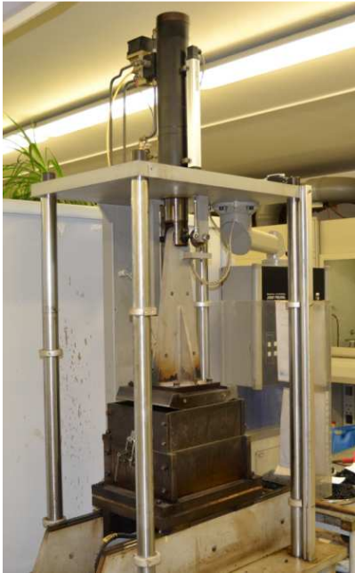
Abbildung 3.1: Walzsektor-Verdichtungsgerät zu Herstellung von Asphaltplatten mit Abmessungen 320 x 260 mm an der TU Dresden
