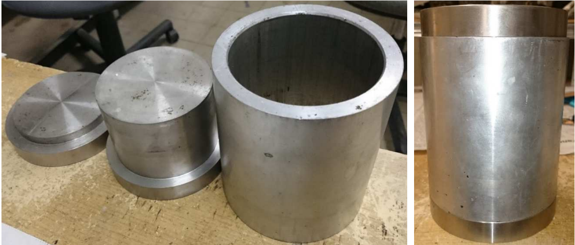
Abbildung 5.25: Speziell angefertigte Form zur Herstellung des Schichtenverbundes zwischen geschliffenen Oberflächen. Links – Teile, rechts – geschlossene Form
