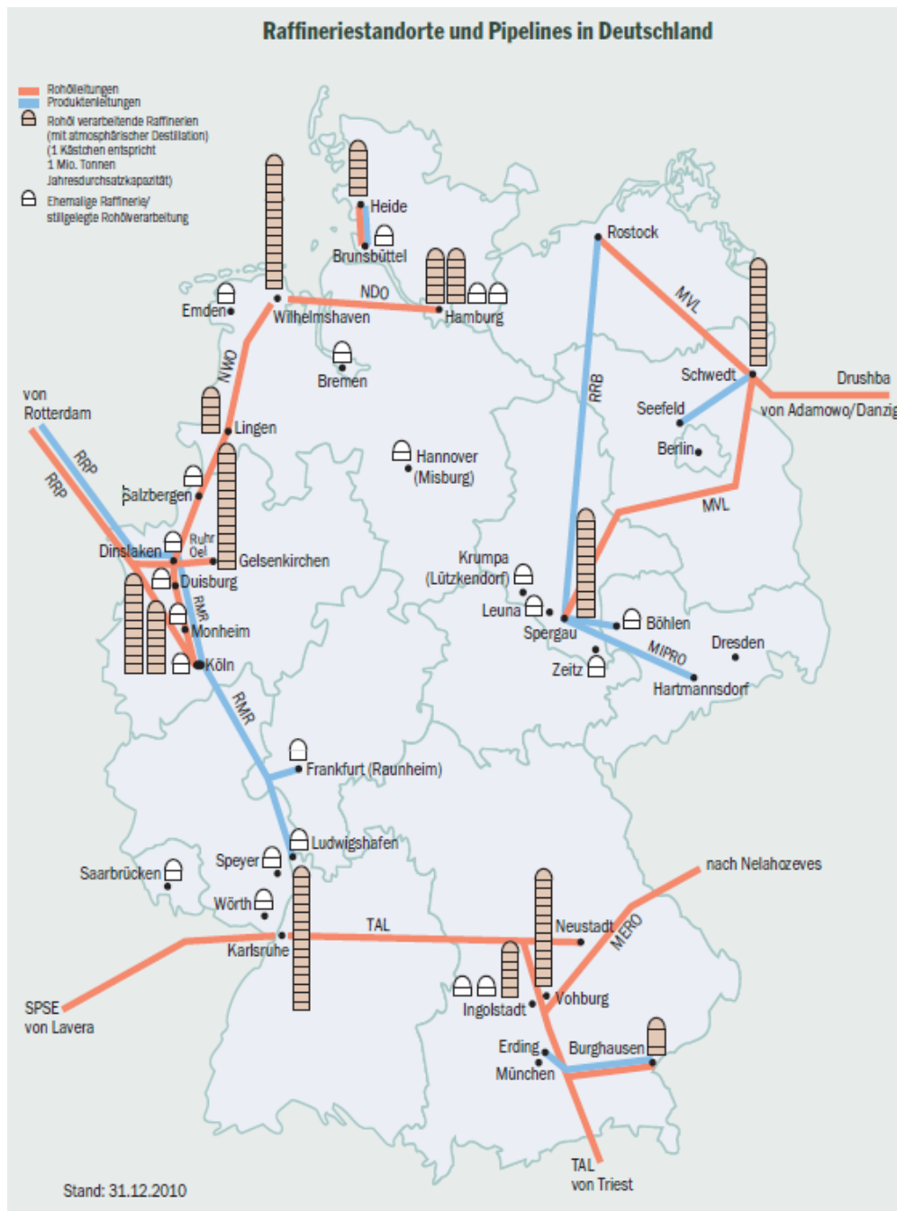
Bild 3-1: Raffineriestandorte und Pipelines in Deutschland [Mineralölwirtschaftsverband]
