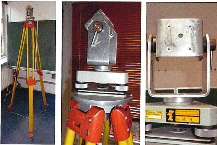
Abbildung 11. Stativ mit Dreifuß, Kippaufsatz und Stativspinne (links), Dreifuß und Kippaufsatz im Detail (Mitte), Bohrloch zur Befestigung der Thermografiekamera im Kippaufsatz (rechts).
