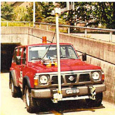
Abbildung 40. Mobile Infrarotmessanlage (IRMU) der EMPA (Stimolo, 2001).
