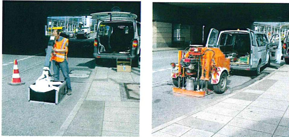
*Bild 22: Messung in-situ und anschließende Bohrkernentnahme.*
