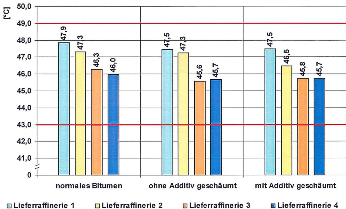
Bild 30: Erweichungspunkt Ring und Kugel der Bitumensorte 70/100; „2 Stunden nach dem Aufschäumzeitpunkt“
