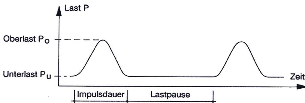
Bild 20: Impulsbelastung – Druckschwellversuch (aus *TP A-StB, Teil: Druckschwellversuch*)
