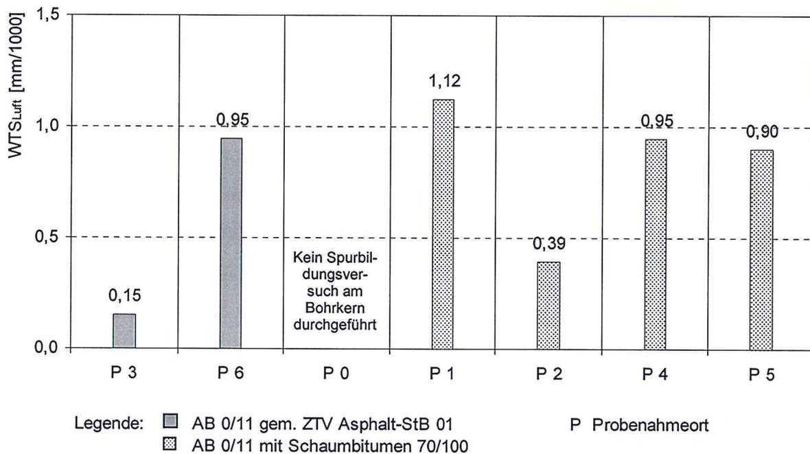
**Bild 56: Bohrkern – Spurbildungsrate  $WTS_{Luft}$**
