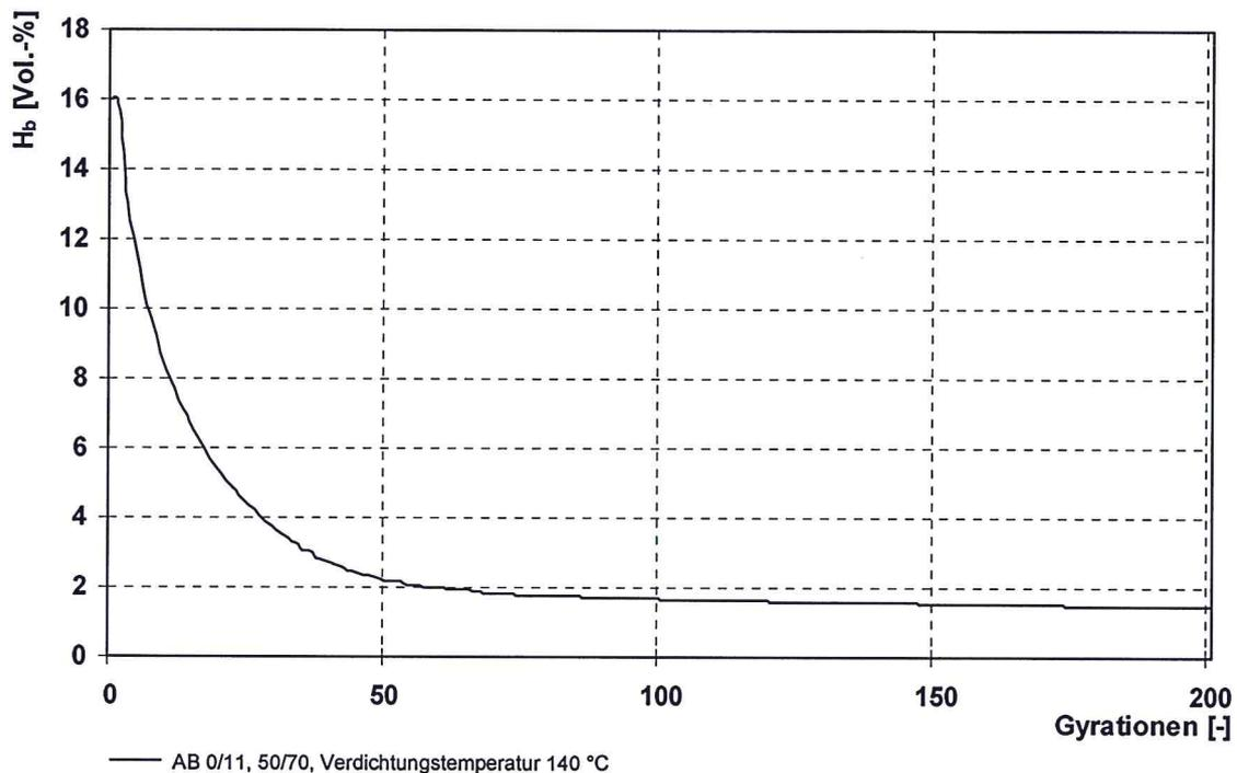
**Bild 13:** Abnahme des berechneten Hohlraumgehalts  $H_b$  in Abhängigkeit von den Gyrationen
