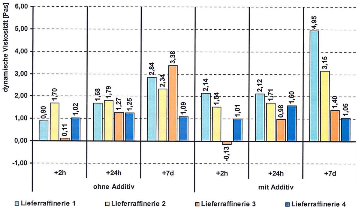
Bild 36: Differenz normal minus aufgeschäumt mit bzw. ohne Additiv dynamische Viskosität der Sorte 70/100
