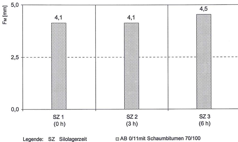
**Bild 49: Silolagerzeit – Marshall-Fließwert  $F_M$**
