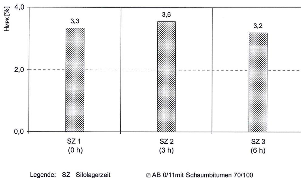
**Bild 47: Silolagerzeit – Hohlraumgehalt am Marshall-Probekörper  $H_{MPK}$**
