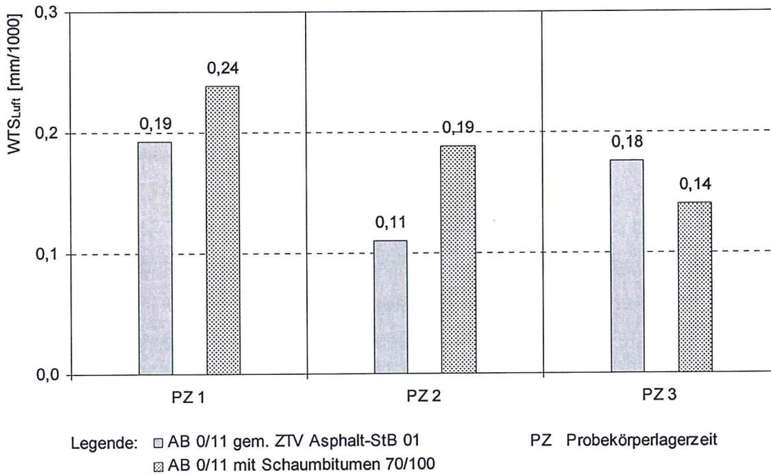
**Bild 42: Mittlere Spurbildungsrate  $WTS_{Luft}$**
