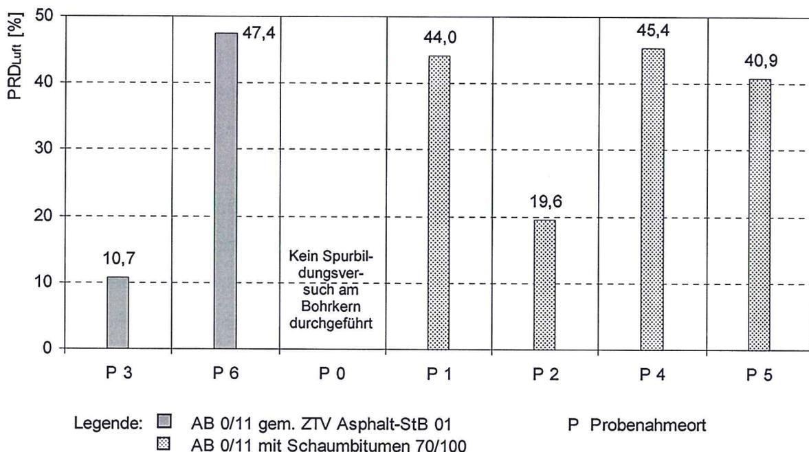
**Bild 57: Bohrkern – Proportionale Spurrinnentiefe  $PRD_{Luft}$**
