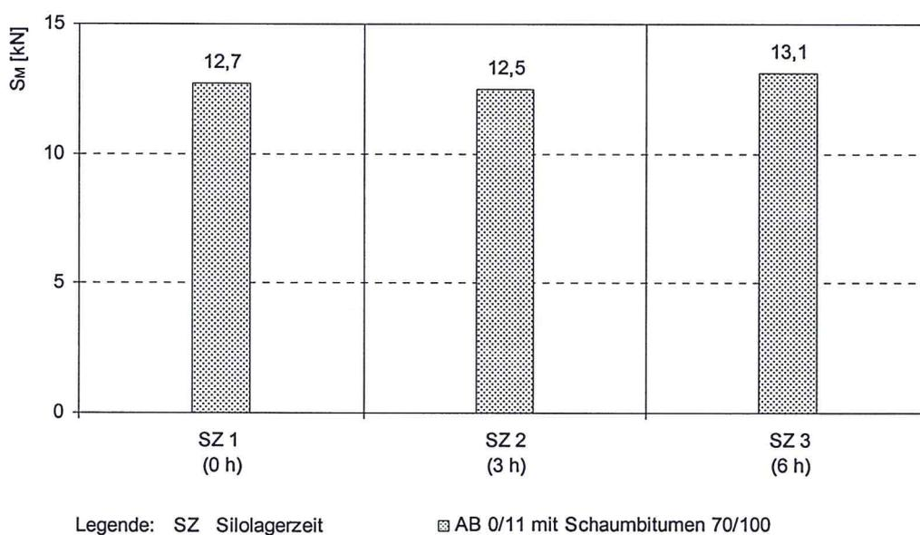
**Bild 48: Silolagerzeit – Marshall-Stabilität  $S_M$**
