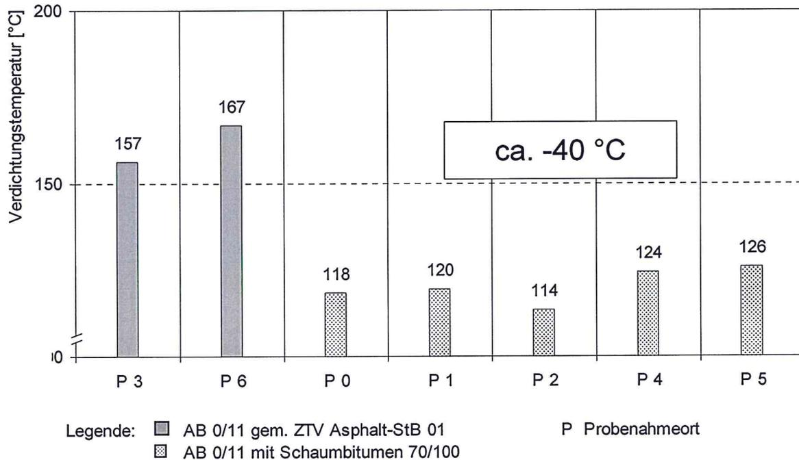
**Bild 54: Teststrecke – Verdichtungstemperatur je Probenahmeort**
