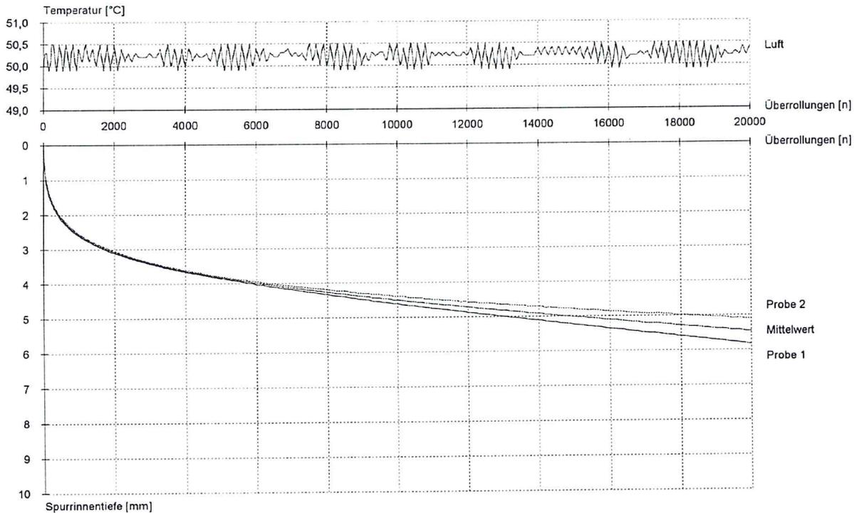
**Bild 17: Zunahme der Spurrinnentiefe in Abhängigkeit von der Anzahl der Überrollungen**
