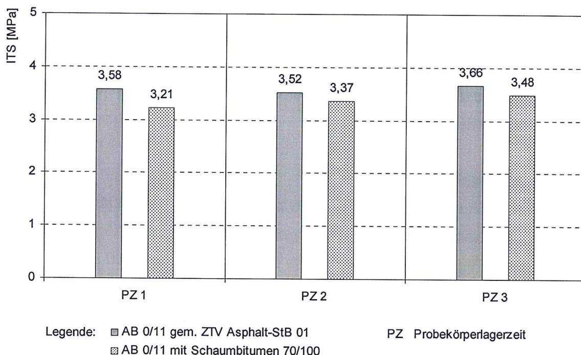
**Bild 44: Indirekte Zugfestigkeit ITS**
