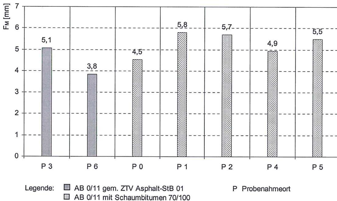
**Bild 59: Großtechnisch hergestelltes Mischgut – Marshall-Fließwert  $F_M$**
