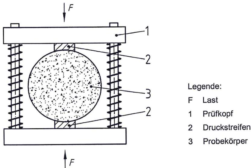
Bild 18: Prinzipskizze – Indirekte Zugprüfung (aus *DIN EN 12697, Teil 23*)
