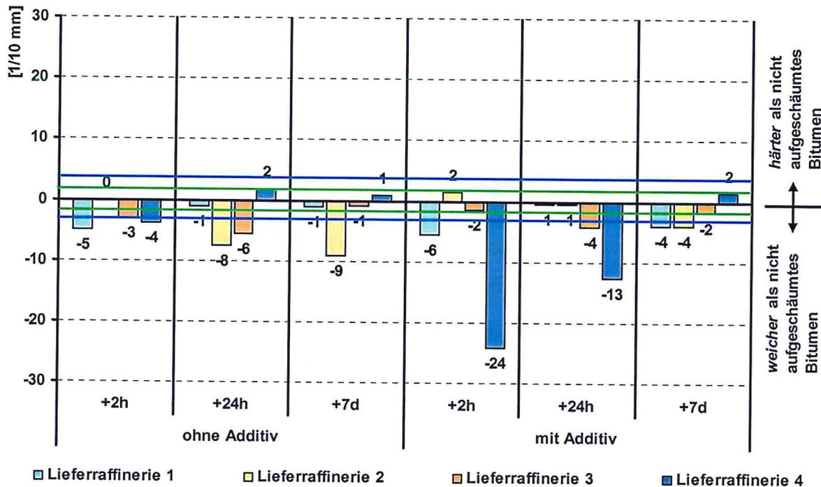
Bild 27: Nadelpenetration der Bitumensorte 50/70: Differenz „nicht geschäumt minus mit/ohne Additiv geschäumt“
