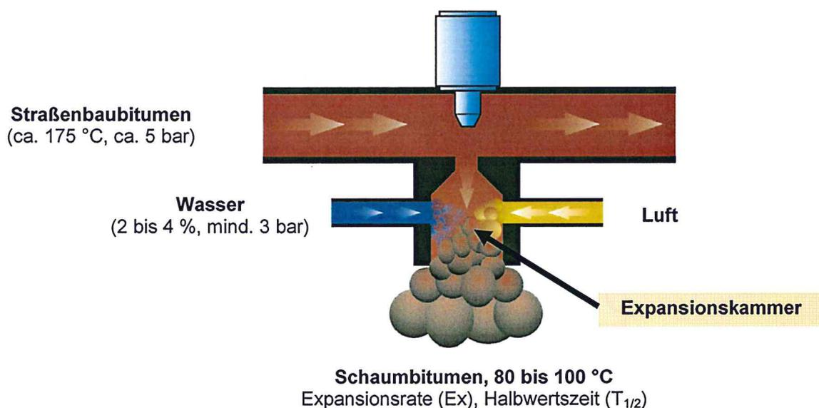
Bild 3: Schaumbitumenherstellung (nach WIRTGEN 2001-b)
