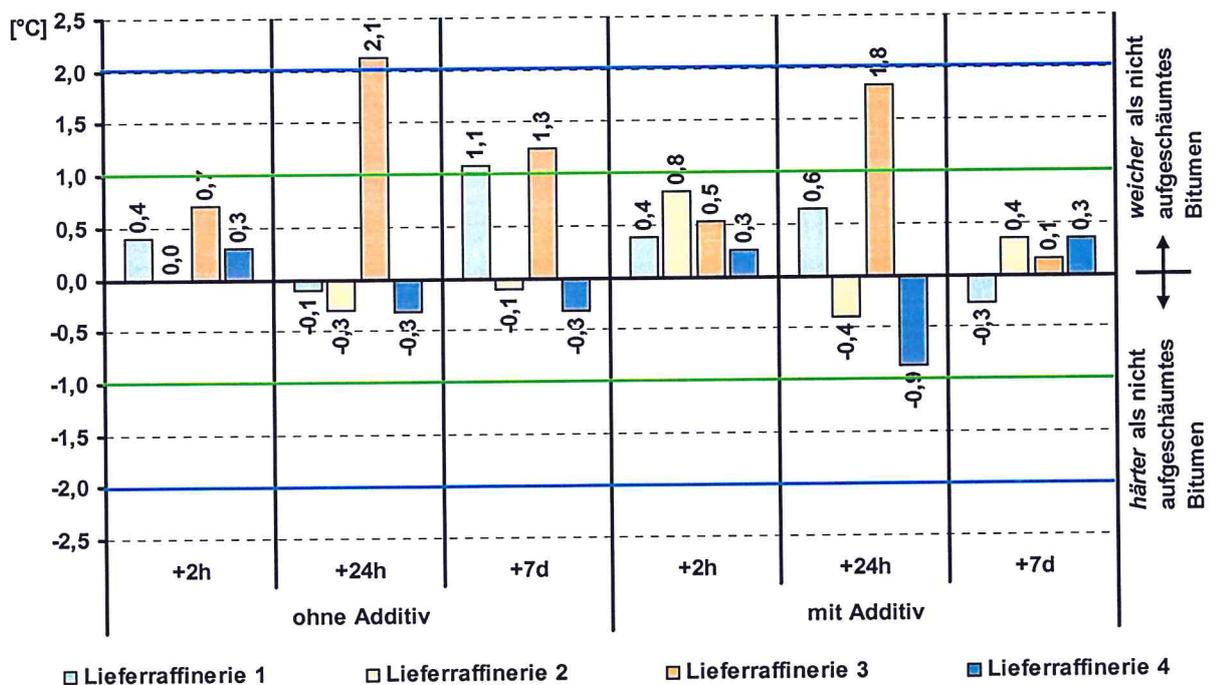
Bild 32: Differenz normal minus aufgeschäumt mit bzw. ohne Additiv Erweichungspunkt Ring und Kugel der Bitumensorte 70/100
