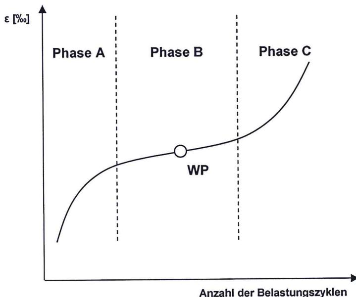
**Bild 21: Kriechkurve – Druckschwellversuch (nach TP A-StB, Teil: Druckschwellversuch)**
