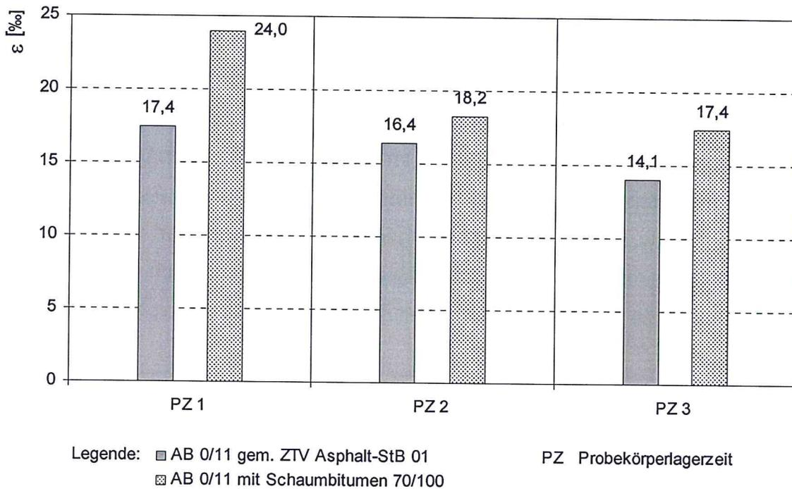
**Bild 46: Dehnung ε nach 10.000 Belastungsimpulsen**
