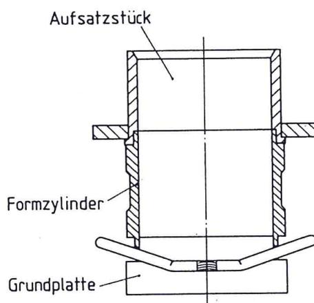
**Bild 5: Verdichtungsform zur Herstellung eines Marshall-Probekörpers (aus *DIN 1996, Teil 4*)**
