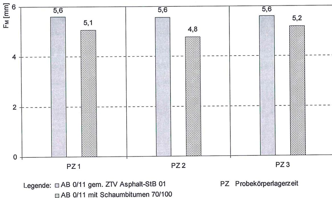
**Bild 41: Marshall-Fließwert  $F_M$**
