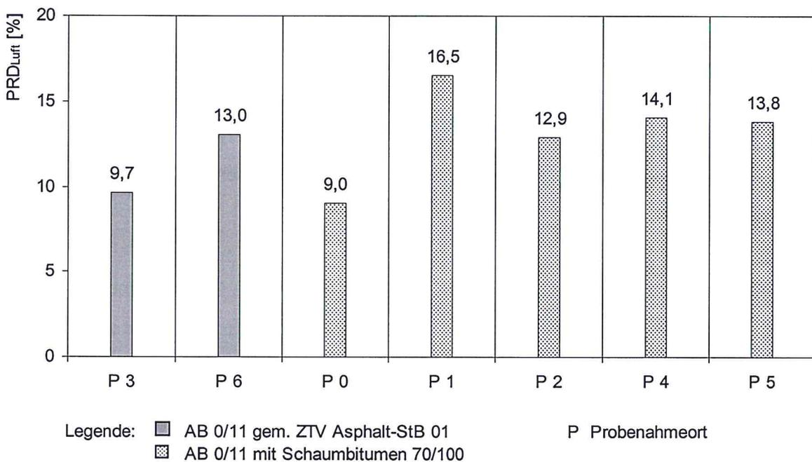
**Bild 62: Großtechnisch hergestelltes Mischgut – Proportionale Spurrinnentiefe PRD<sub>Luft</sub>**
