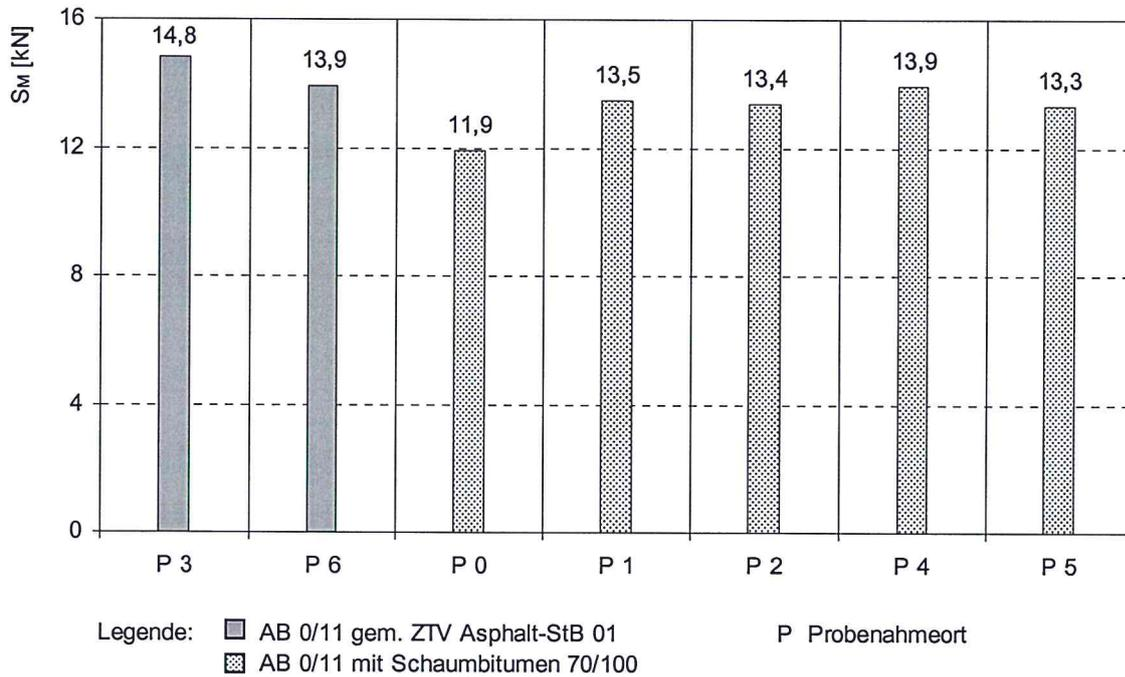
**Bild 58: Großtechnisch hergestelltes Mischgut – Marshall-Stabilität  $S_M$**
