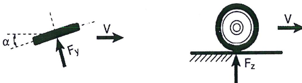
Bild 22: Schräglaufwinkel  $\alpha$ , Seitenreibungskraft  $F_y$  und Normalkraft  $F_z$  (aus TP Griff-StB)
