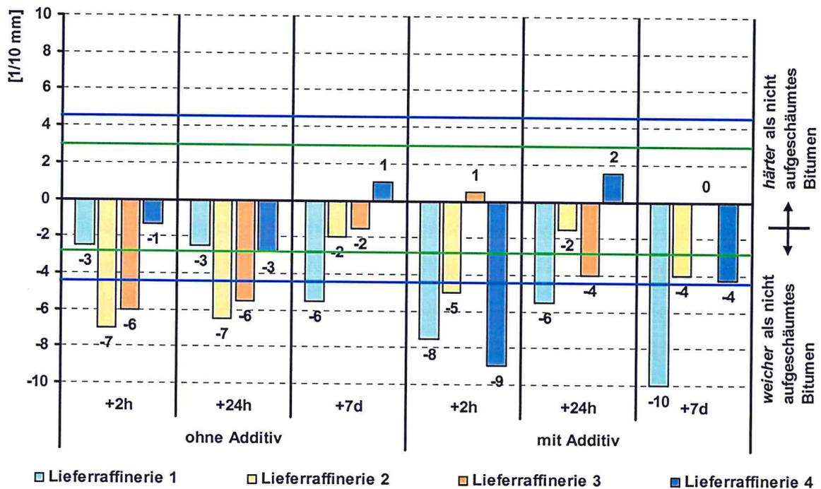
Bild 28: Nadelpenetration der Bitumensorte 70/100: Differenz „nicht geschäumt minus mit/ohne Additiv geschäumt“
