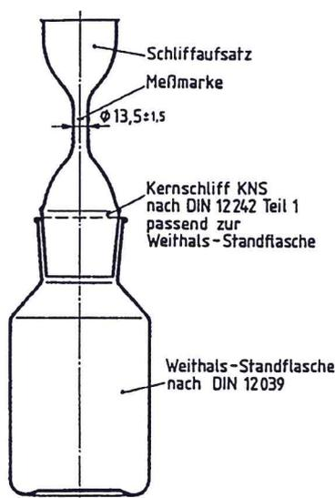
**Bild 10: Pyknometer zur Bestimmung der Rohdichte
