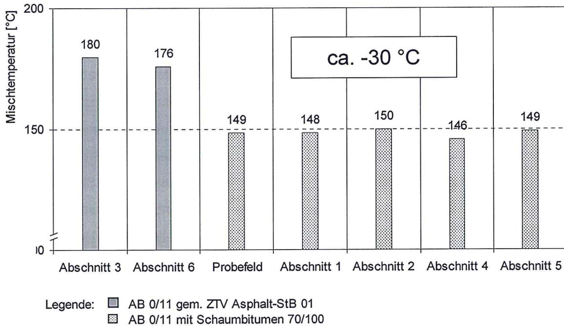
**Bild 53: Teststrecke – Mischtemperatur je Abschnitt**
