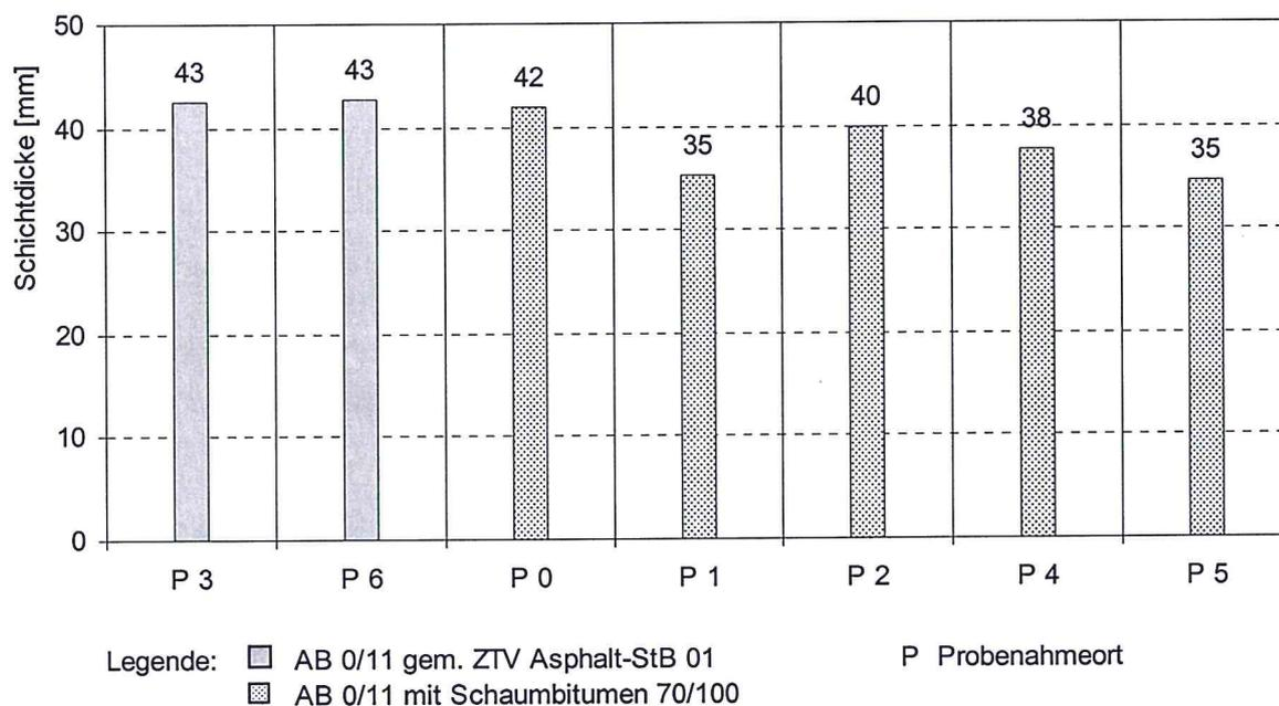
**Bild 55: Bohrkerne – Mittlere Schichtdicke**
