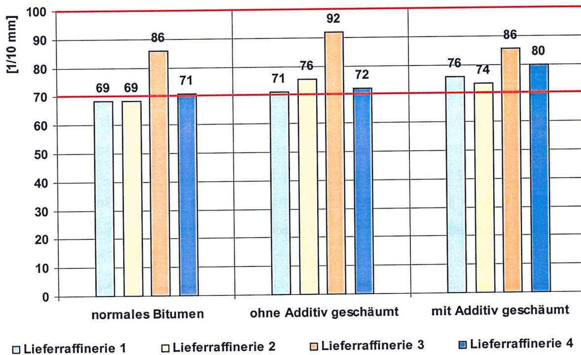
Bild 26: Nadelpenetration der Sorte 70/100; „2 Stunden nach dem Aufschäumzeitpunkt“
