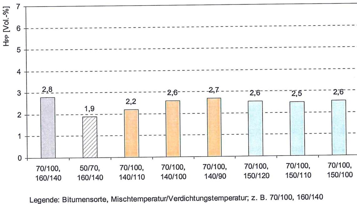
**Bild 39: Hohlraumgehalt an Probekörpern  $H_{PP}$**
