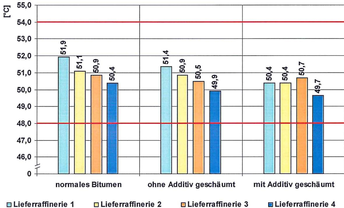
Bild 29: Erweichungspunkt Ring und Kugel der Bitumensorte 50/70; „2 Stunden nach dem Aufschäumzeitpunkt“
