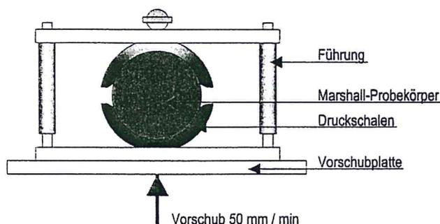
**Bild 14: Druckvorrichtung (Marshall) – Prinzipskizze (aus WEHNER)**
