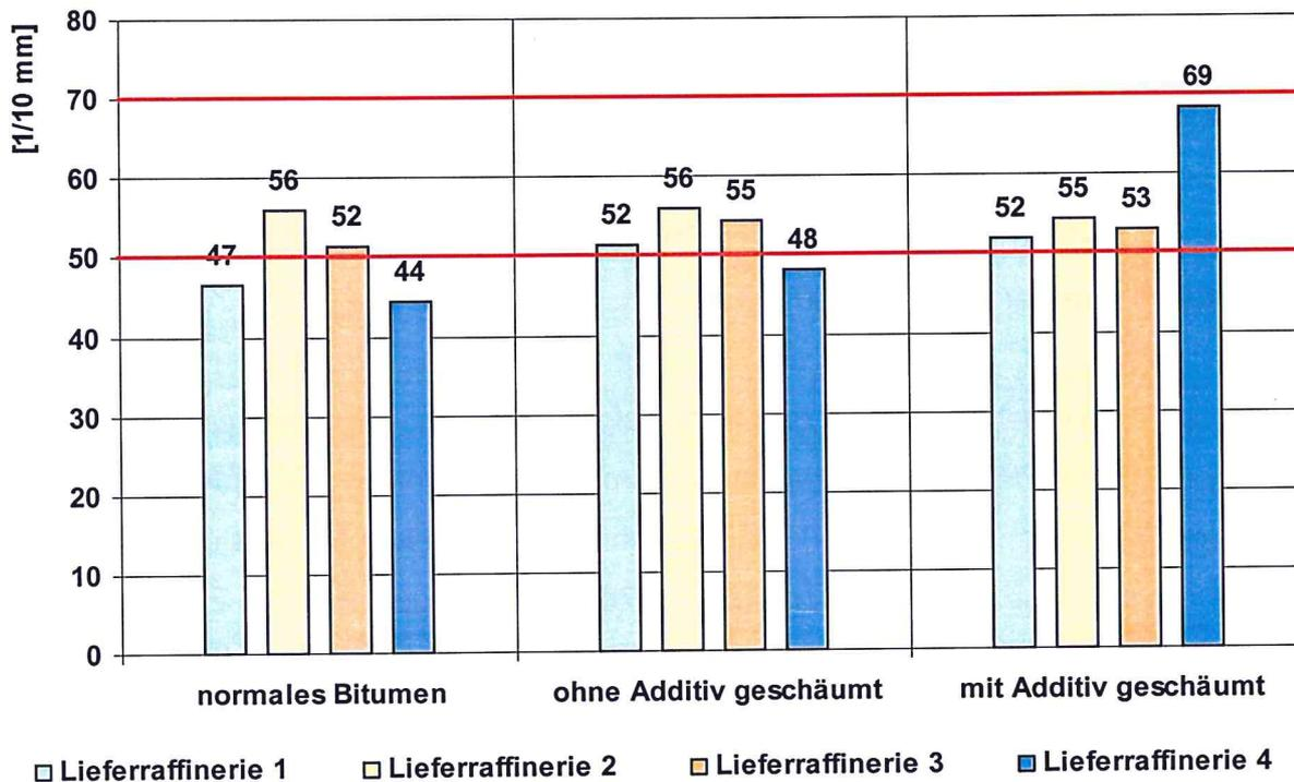
Bild 25: Nadelpenetration der Sorte 50/70; „2 Stunden nach dem Aufschäumzeitpunkt“
