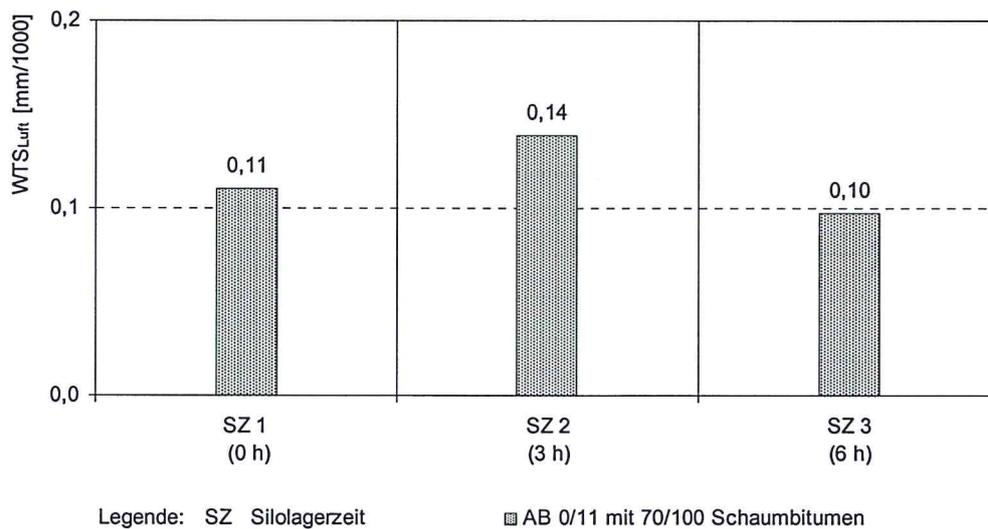
**Bild 50: Silolagerzeit – Spurbildungsrate WTS<sub>Luft</sub>**
