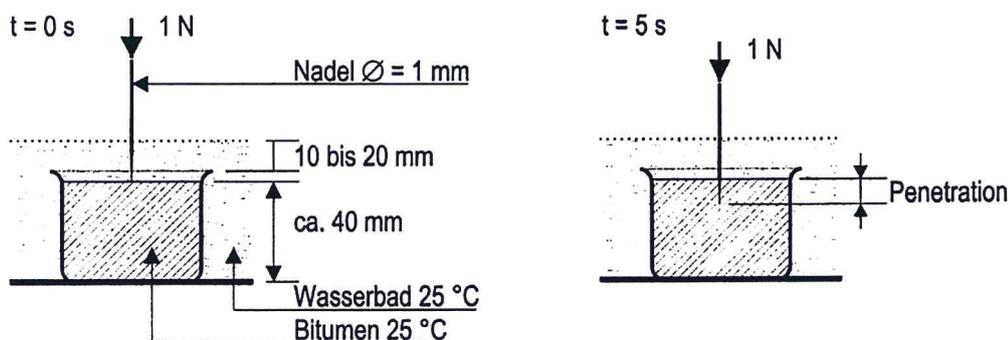
Bild 7: Prinzipskizze – Nadelpenetration NP (aus BECKEDAHL)
