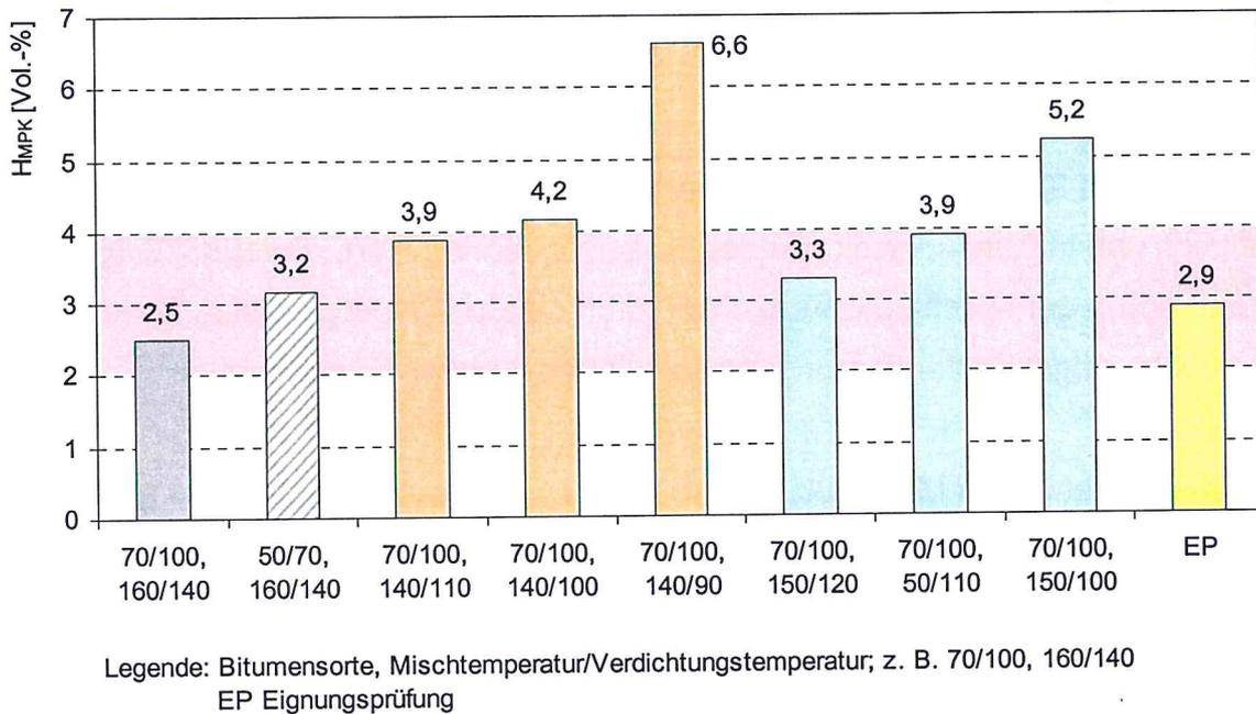
**Bild 38: Hohlraumgehalt am Marshall-Probekörper  $H_{MPK}$**
