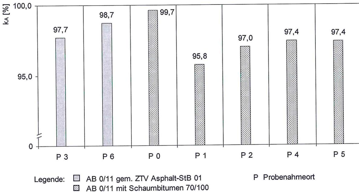
**Bild 52: Teststrecke – Verdichtungsgrad**
