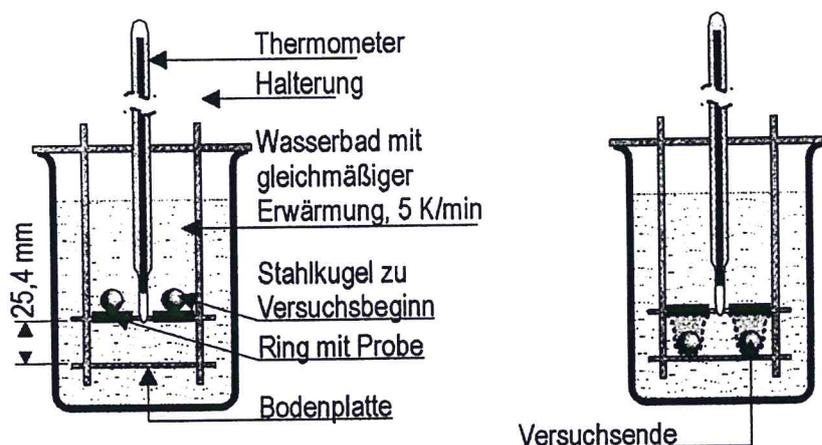
Bild 8: Prinzipskizze – Erweichungspunkt Ring und Kugel EP RuK (aus BECKEDAHL)
