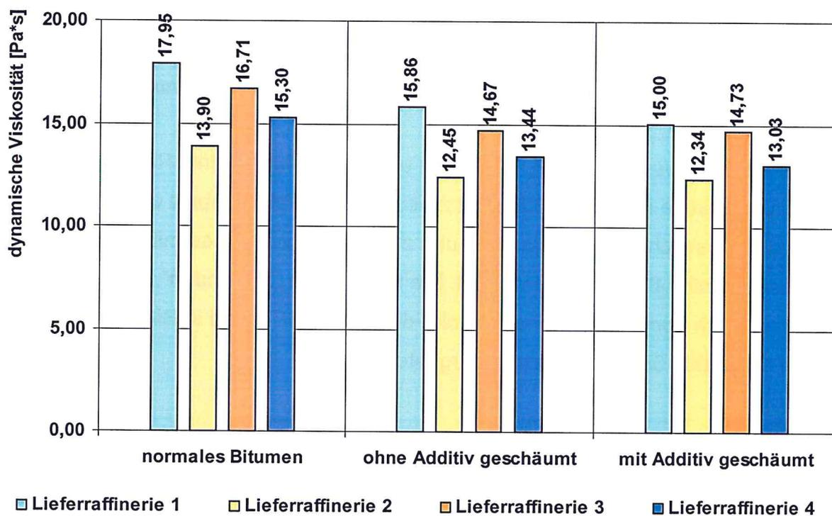
Bild 33: Dynamische Viskosität der Sorte 50/70; „2 Stunden nach dem Aufschäumzeitpunkt“
