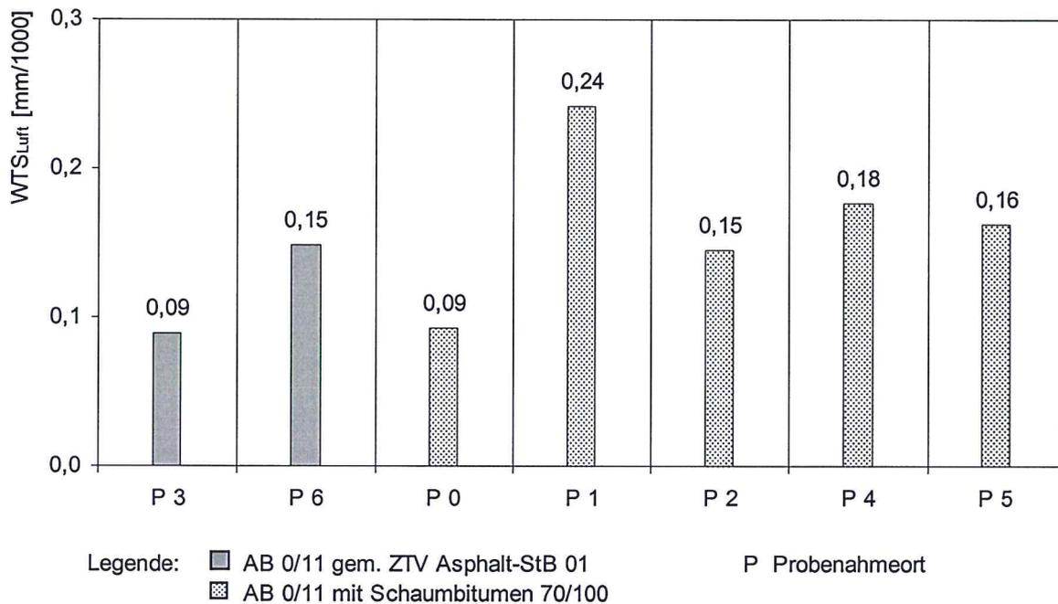
**Bild 61: Großtechnisch hergestelltes Mischgut – Spurbildungsrate WTS<sub>Luft</sub>**
