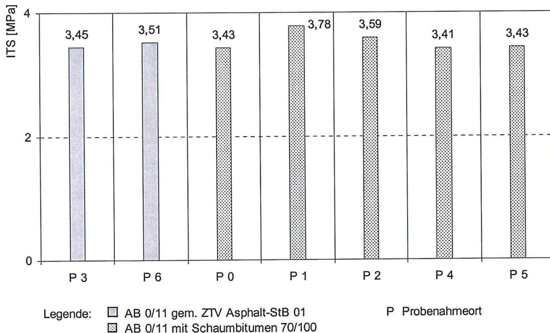
**Bild 60: Großtechnisch hergestelltes Mischgut – Indirekte Zugfestigkeit IST**
