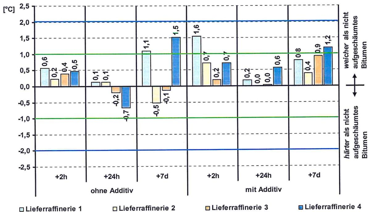
Bild 31: Differenz normal minus aufgeschäumt mit bzw. ohne Additiv Erweichungspunkt Ring und Kugel der Bitumensorte 50/70
