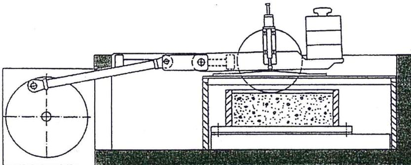
**Bild 16: Prinzipskizze – Spurbildungsgerät (aus BECKEDAHL)**
