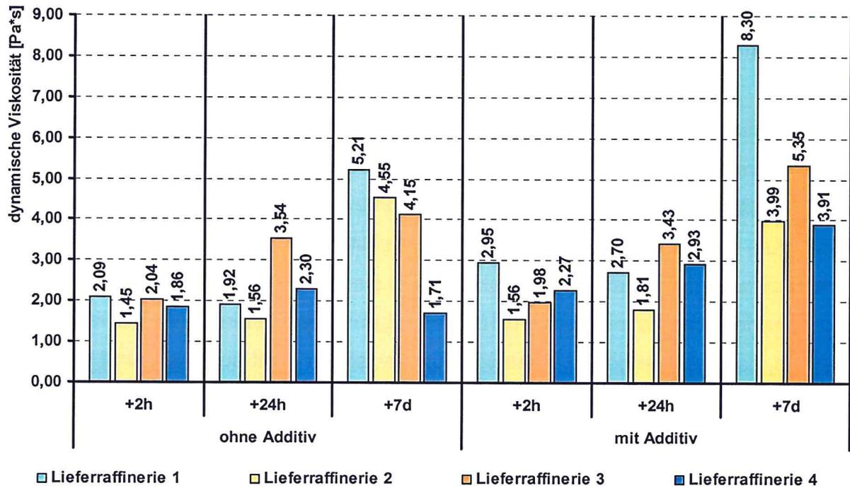
Bild 35: Differenz normal minus aufgeschäumt mit bzw. ohne Additiv dynamische Viskosität der Sorte 50/70
