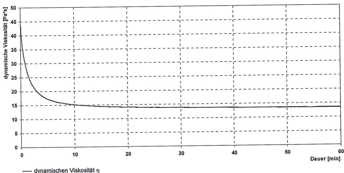
**Bild 9: Abhängigkeit der dynamischen Viskosität  $\eta$  von der Belastungsdauer**
