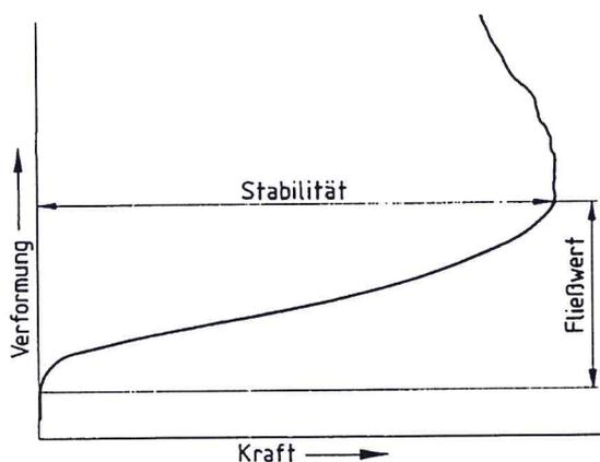
**Bild 15: Kraft-Verformungsdiagramm (aus DIN 1996, Teil 11)**
