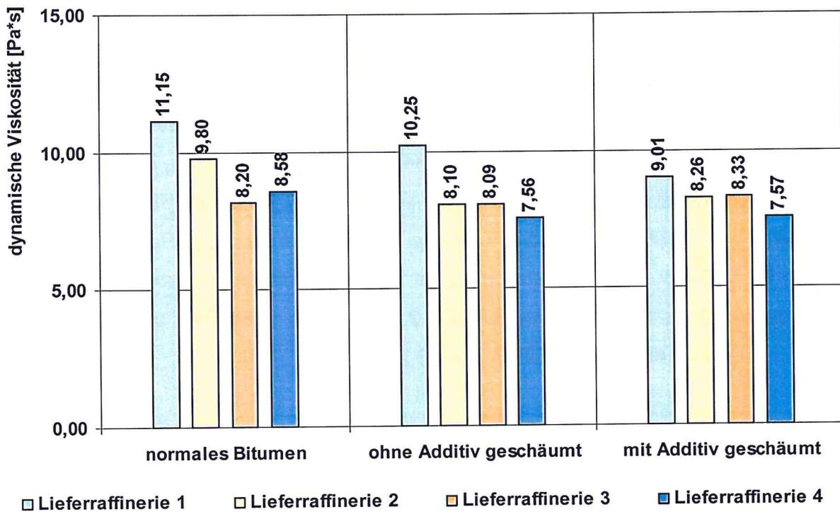
**Bild 34: Dynamische Viskosität der Sorte 70/100; „2 Stunden nach dem Aufschäumzeitpunkt“**
