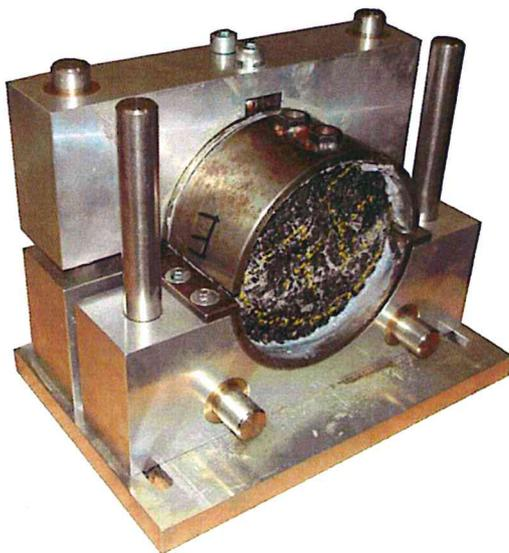
Abbildung 44: Probenvorbereitungsvorrichtung
