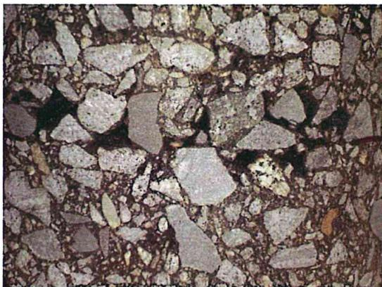
**Abbildung 1: Ausrichtung der Gesteinskörner und Hohlräume an der Schichtengrenzfläche (ABi 0/16 S / ATS 0/22 CS)**
