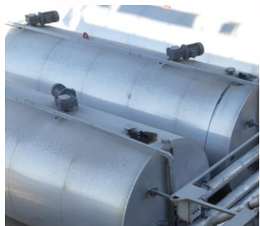
Einspeisung in den Lagertanks mit Mischer und Umwälzung
