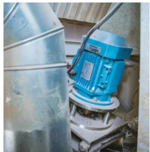
Bitumen-Waage mit Rührwerk
