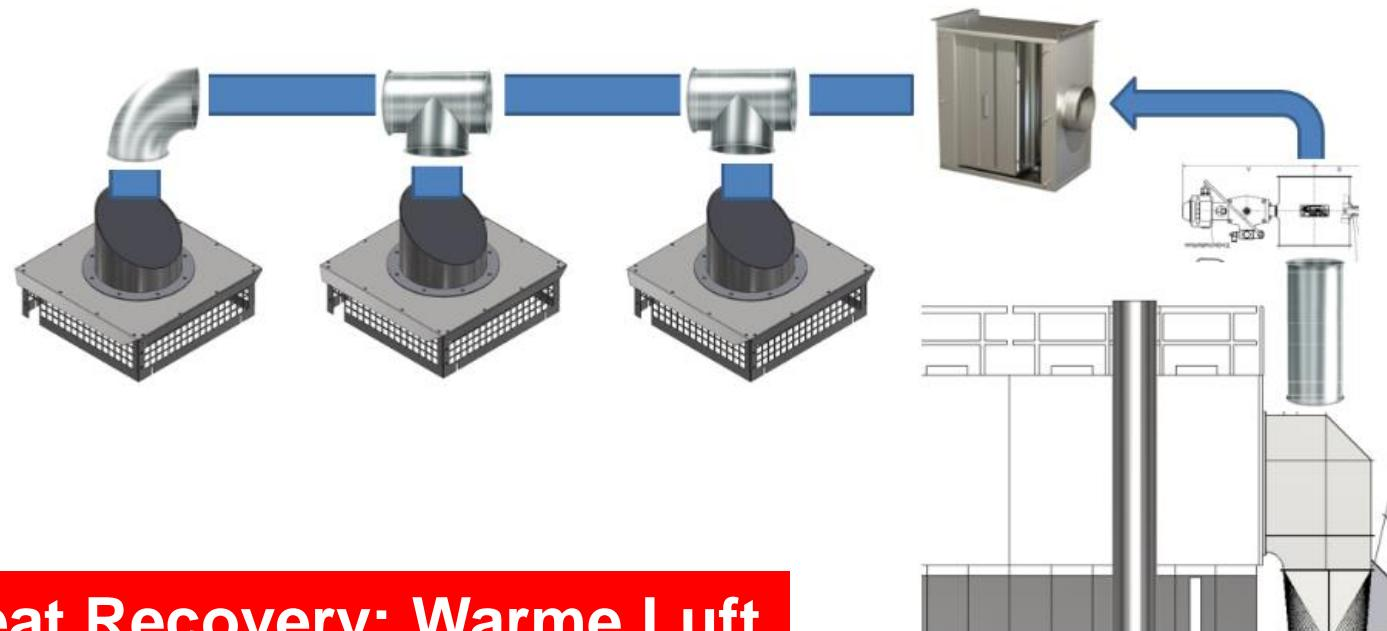
**Heat Recovery: Warme Luft aus dem Reingaskanal für die Abreinigung nutzen.**
